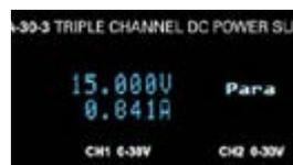
При последовательном или параллельном соединении двух каналов 30 В выходное напряжение или ток увеличиваются в два раза, достигая 60 В и 6 А.
