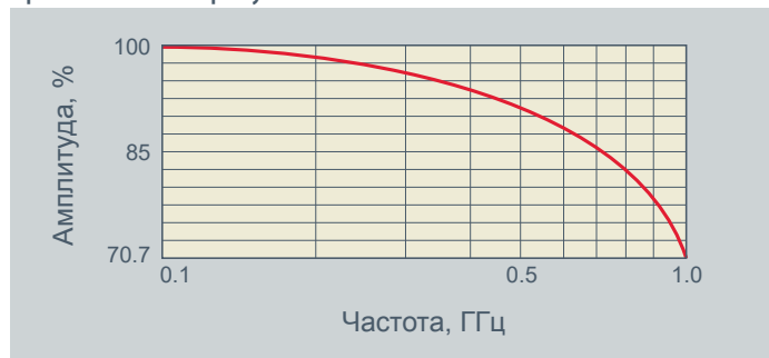
Рис. 1. Типовая амплитудно-частотная характеристика осциллографа общего назначения
